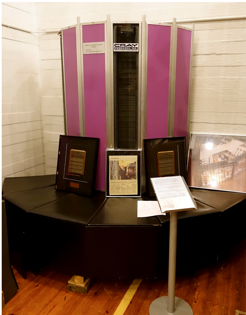
Cray-1S-supertietokone (alkuperäismallin julkaisu 1976). Crayssa tornin pyöreä muoto minimoisen sisään asennettujen johtojen pituuden ja penkki kätkee sisäänsä virtalähteen. Kirjoitimme Craysta ja muista supertietokoneista Skrollissa 2014.1 otsikolla ”Laskentatehon linnakkeet”. Jutussa käsitellään myös myöhempiä supertietokoneita Suomessa. Saat maksuttoman pdf-lehden osoitteesta skrolli.fi/numerot , ja paperilehti on vielä myynnissä osoitteessa skrolli.fi/kauppa . (Kuva: Janne Sirén)
